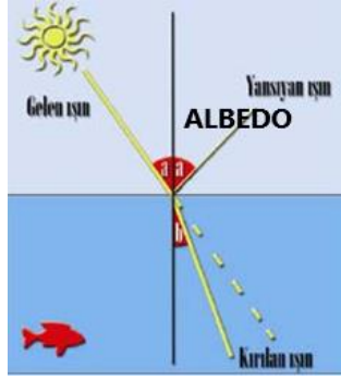
Şekil 7: Gelen Işın, Yansıyan Işın, Kırılan Işın ve Albedo (Riveros, 2019)
